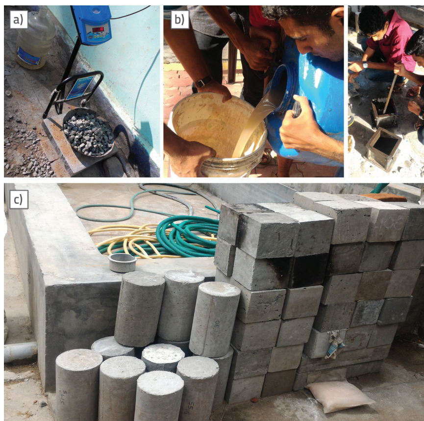
Slika 1. Postupak izrade i njegovanja geopolimernog betona: a) vaganje sastojaka; b) miješanje i izrada uzoraka za ispitivanja (kocki i valjaka); c) njegovanje uzoraka
