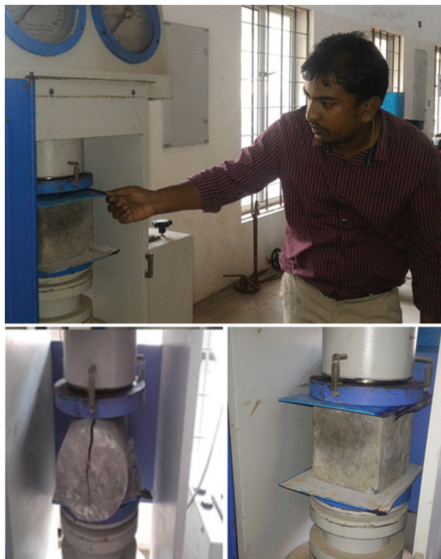
Slika 5. Postav ispitivanja tlačne i vlačne čvrstoće cijepanjem
