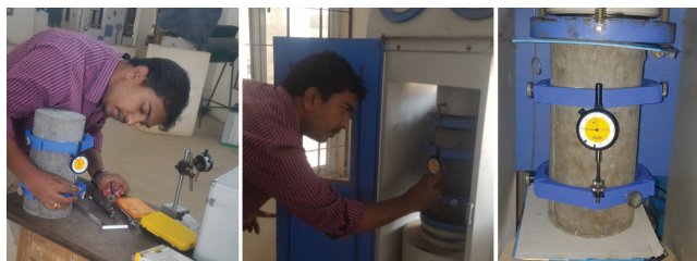
Slika 3. Postav ispitivanja za određivanje Youngova modula
